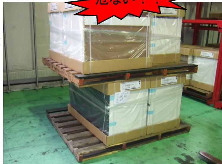
解説: 一見大丈夫そうな段積みパレットですが、実は非常にバランスが悪い段積みになっています。重さの重心が片寄るとリフト作業をした際に転倒などの事故が発生します。時にはパレット揃えではなく荷物揃えで段積みすることも必要です。
