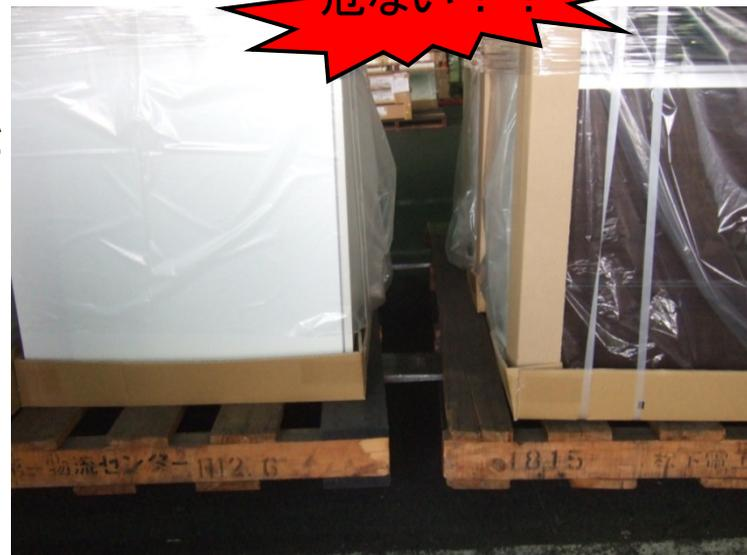
解説: 一見問題なさそうですがリフトの爪が後ろのパレットまでかかっています。またパレットだけではなく後ろの商品を爪突きしたり押ししたりします。リフトの爪の長さやパレットの奥行きを確認しないと大きな事故が発生します。リフトの爪に白いラインで印をつけるのはこういった事故を防止するためです。
