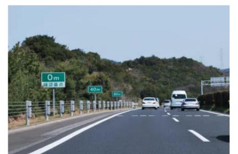
高速道路に設置されている車間距離確認表示板
